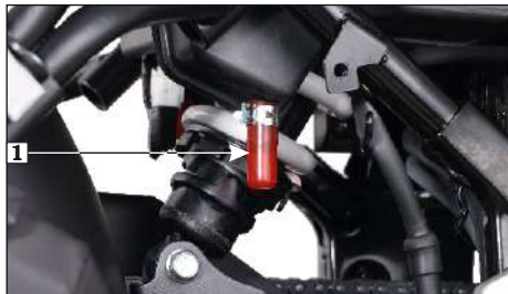
(1) Tubo de drenaje
