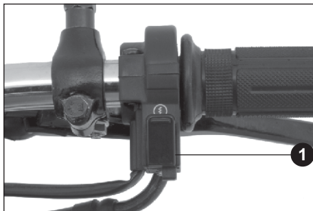
(1) Interruptor del arrancador eléctrico
